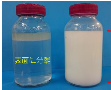
油脂と水を薬さじで攪拌（10分静置後）
