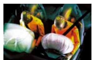
自動車用エアバック試験
