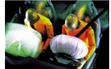
自動車用エアバック試験 日油のガス発生剤・点火薬が使用されてい る自動車用エアバック
