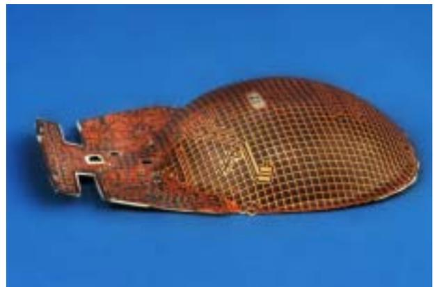
三次元実装モジュール試作基板
