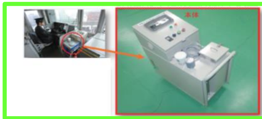
鉄道用凍結防止剤散布操作盤
