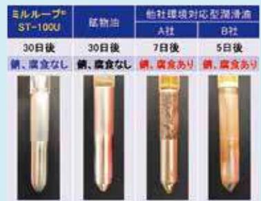
防錆性能比較試験結果 (60°Cの潤滑油: 天然海水(95:5)液中に一定時間浸漬し、腐食状況を比較)
