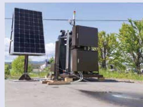
冬場の凍結した雪氷路面を自動車が行くと、タイヤがスリップして交通事故が発生する危険があります。競合品の凍結防止剤は塩化物系が主流ですが、日本工機が販売する塩素を含まない凍結防止剤「カマグ®」は、金属・コンクリートなどの構造物や自然環境への塩害を発生させません。また、自動散布装置「オートカマグ®」はソーラーパネルを備えた、無電源で稼働できるタイプもあり、省エネルギーに貢献します。
