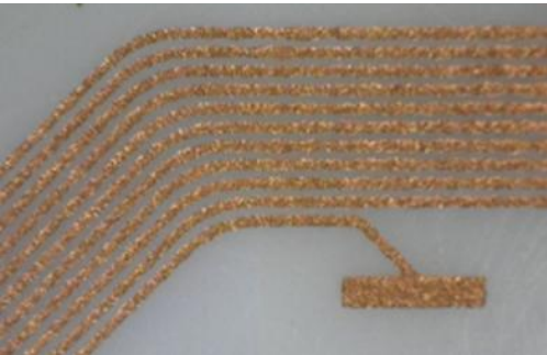
スクリーン印刷例 Example of screen printing SUS400 mesh squeeze speed: 50 mm/s
