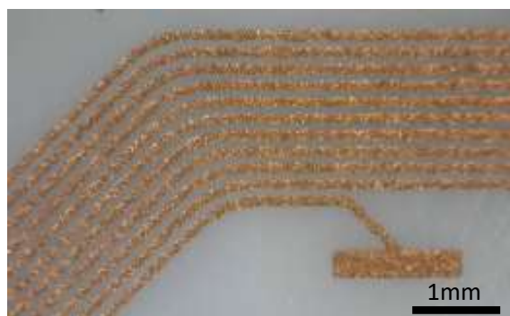
スクリーン印刷例 SUS400メッシュ スキージスピード：50mm/s
