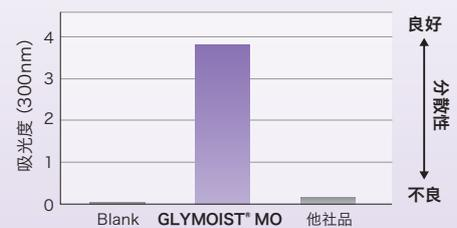
实验方法: 在97.3%十二烷中添加0.2%的甘油油酸酯进行搅拌 → 添加二氧化钛2.5%进行搅拌 → 静置后测定吸光度
