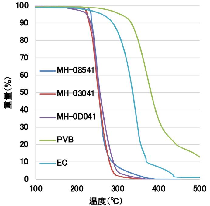
PVB: 聚乙烯醇缩丁醛、EC: 乙基纤维素、升温速度: 10°C/min
