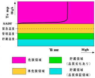
弊社における有機過酸化物の熱安定性評価では、上記したSADT測定の他にDSC測定、急速加熱測定、さらにもっともスケール効果が定量的に評価できるARC測定を行っています。ARCは以下に述べるように有機過酸化物の熱安定性の評価法として非常に有効な手法であります。
