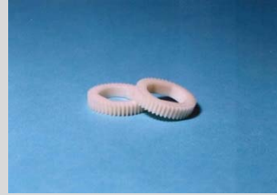
摺動性改良剤 モディパー® A (歯車の磨耗低減)
