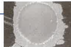
Z アイアン (Features) Z アイアンは、中心部が鉄核で、その外殻部が亜鉛・鉄合金です。 Particle with Zn/Fe alloy surface and Fe core
