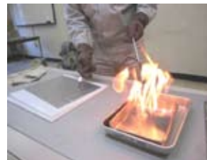
静電気着火 尼崎工場
